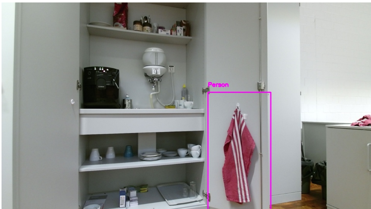
Abbildung 4.13: Veranschaulichung einer fehlerhaften Personenerkennung. Das dargestellte Küchentuch wurde von der HOG-SVM Kombination als Person klassifiziert.
